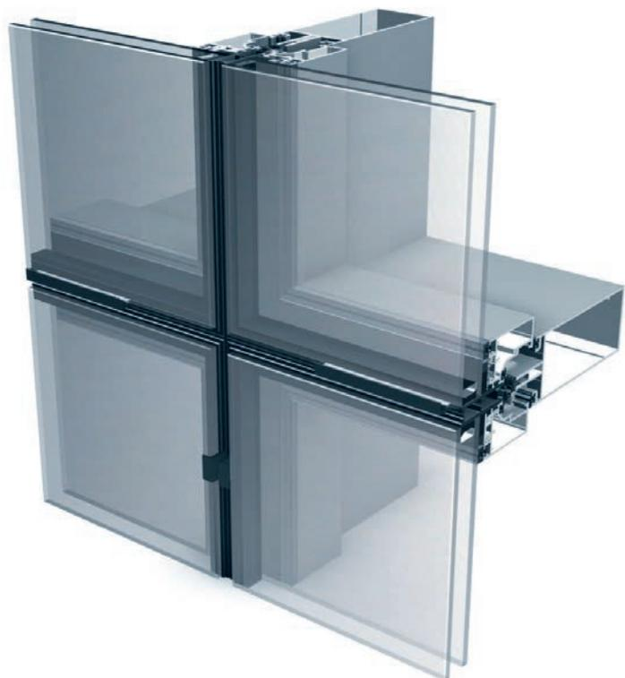
Elegance 52 SG est un système de profilés en aluminium pour mur-rideau avec Vitrage Extérieur Collé (VEC). Elegance 52 SG est une solution ne présentant aucune différence visuelle entre les panneaux fixes et les ouvrants. Système intégré de fenêtre ouvrant caché vers l'extérieur.
