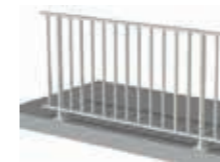
Barreaudage sous main courante
